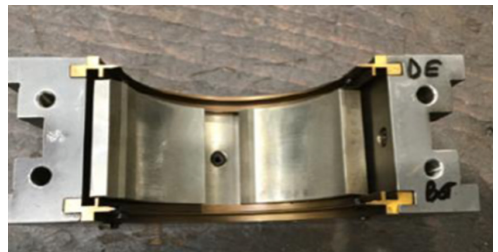
Typiskt "tilting pad" lager för renovering
